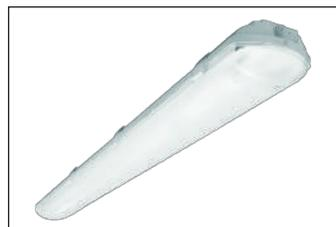
Antivandálico, resistente a la corrosión y retardante a la flama. Cuerpo de policarbonato, junta de poliuretano líquido en su perímetro, sellado con clips de policarbonato. Temp. de operación ambiente: -40°C a 50°C
