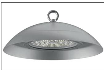
Suspender o sobreponer. Cuerpo de aleación de aluminio con forma arqueada, a prueba de polvo. Óptica de policarbonato disponibles en 120°, 90° y 50°. Temp. de operación: -30°C a 50°C
