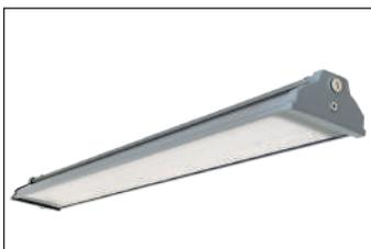
Luminario hermético de alta resistencia mecánica. Cuerpo de lámina de acero galvanizado resistente a la corrosión. Cabeceras de aluminio fundido. Difusor de policarbonato, sellado. Temp. de operación: -40°C a 50°C
