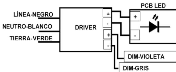
NOTA: Si no utiliza el cable de dimeo, aisle ambos extremos.
