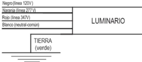
\*Para algunos modelos las conexiones son unicamente: 120V/277V
